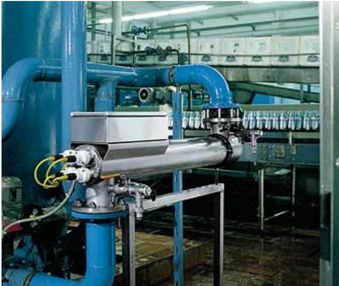
Desinfección ultravioleta WEDECO en la industria de las bebidas, Christinenbrunnen, Alemania.
